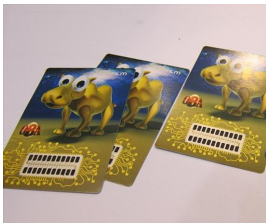
図 4 ThinFilm Electronics のゲームカード. 同社の IJ 技術によるメモリを形成し、ゲームカードへの検討が進行しているという。
