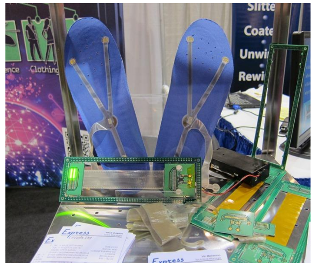
図 8 Express Circuit 社のウレタン薄膜基板上へのジグザグ配線を形成したストレッチャブル配線の展示。ウェアラブルデバイスへの展開を強調していた。ただし、印刷ではなくエッチング。
