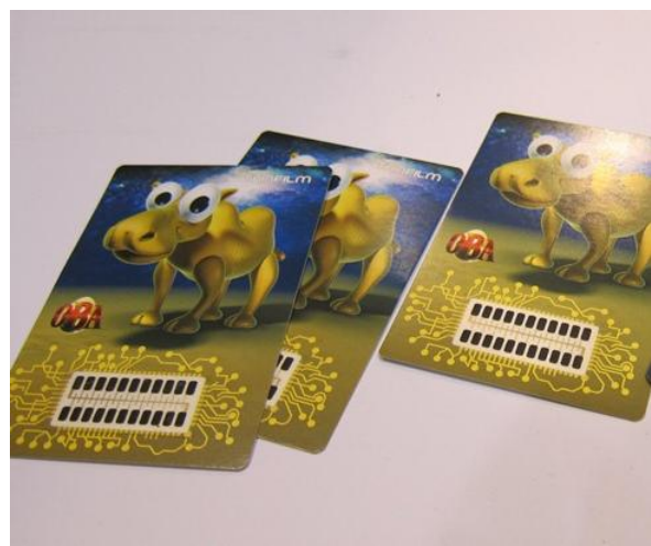
図 4 ThinFilm Electronics のゲームカード.同社の IJ 技術によるメモリを形成し、ゲームカードへの検討が進行しているという。
