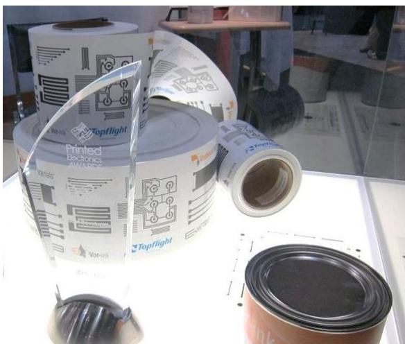
図 3 Vorbeck Material 社のグラフェン配線で、グラフェンの独自の量産法を確立し、透明ではないが紙基板への印刷配線を行った。
