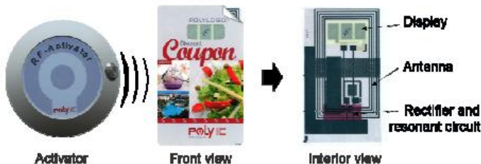
左図：無線起動装置（Activator）および、RF アンテナとエレクトロクロミックディスプレイをもつデバイスのイメージ
