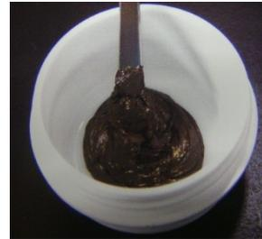
図 14 パワーデバイス接合用フローメタル
