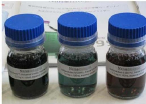
図 30 左：高純度グラフェンタイプ、中央：金属性単層カーボンナノチューブタイプ
