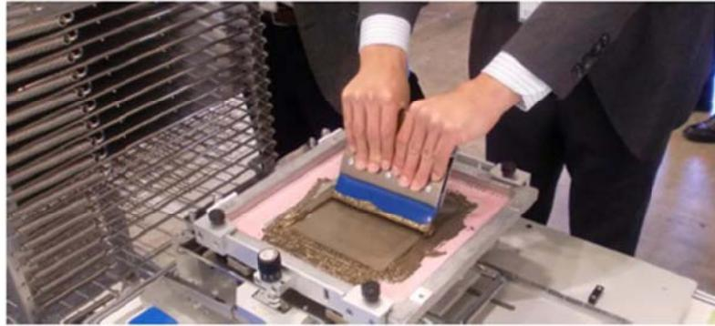
図 27 ラインアンドスペース 30 $\mu\text{m}$  配線の手刷り体験のデモの様子
