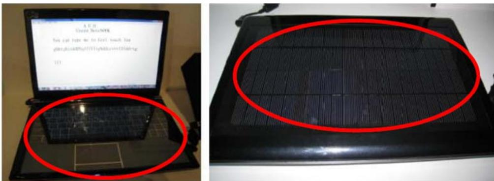
図 24 太陽電池内臓ラップトップ(赤枠内は、太陽電池部)
