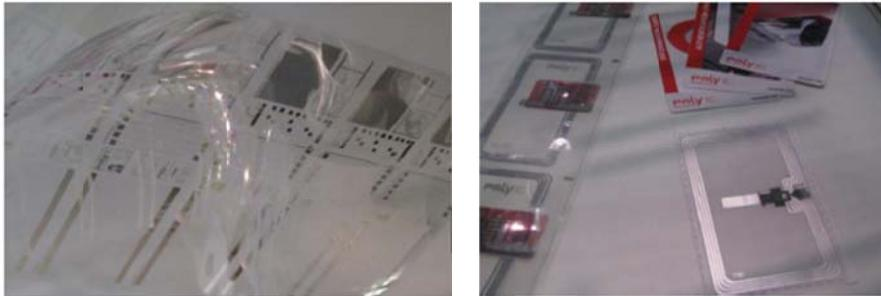
図 8 左：透明導電膜、右：印刷 RFID タグ
