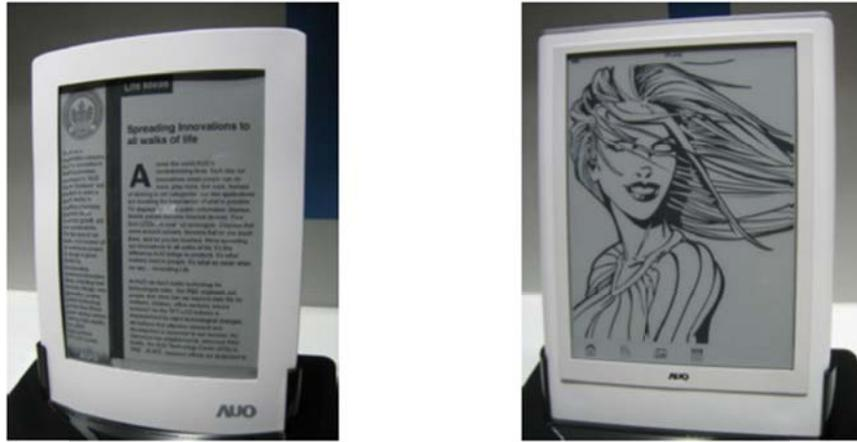
図 21 左：6 型モノクロ電子ペーパー、右：9 型モノクロ電子ペーパー
