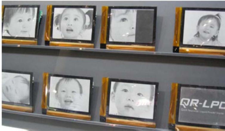
図 18 モノクロ電子ペーパーの切り替わる様子
