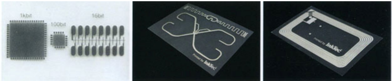
図 2 インクジェット印刷によって、PET 基板上に描画した配線
